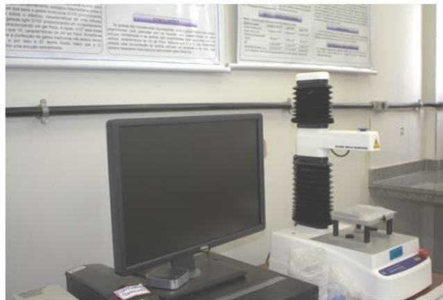
Figura 14 – Equipamento para análise de textura (Texturômetro)
