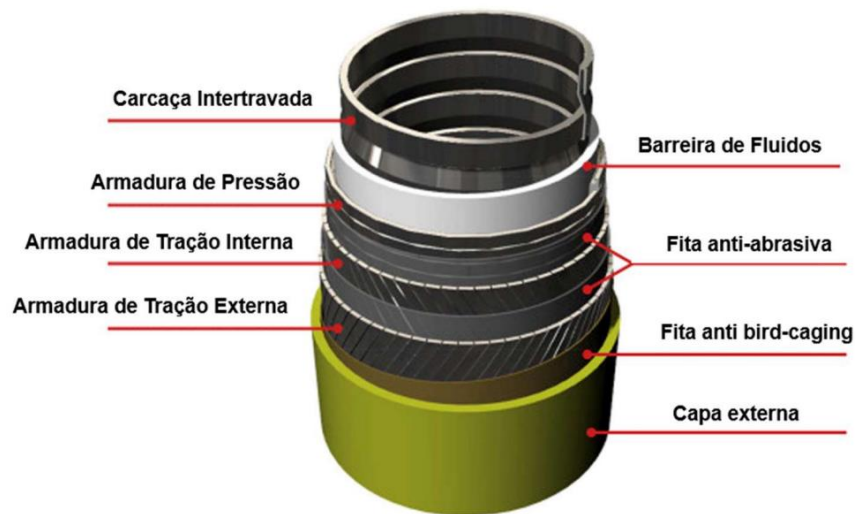
Figura 1 - Camadas de um riser flexível.
