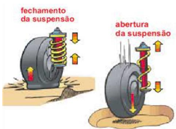
Figura 3- Sistema de amortecimento veicular ao passar por um obstáculo (DANA, 2020)
