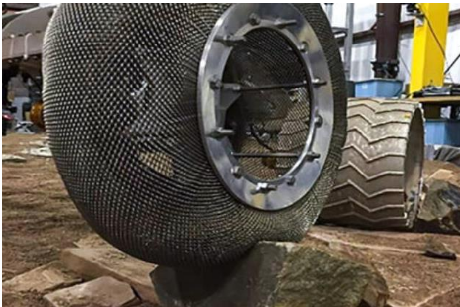
Figura 18- Pneu com roda composta de liga com memória de forma aplicado em Rovers desenvolvidos pela NASA (ZAMBELLI et. al. , 2021)
