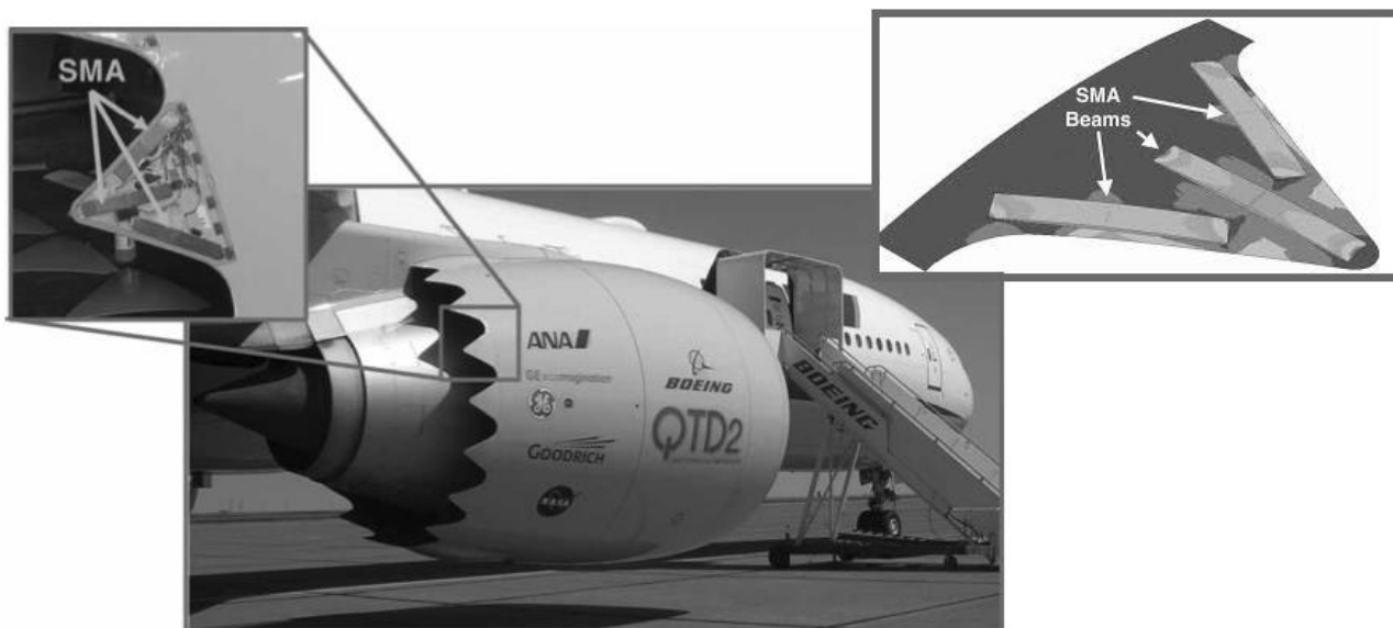
Figura 17- Chevrons de Geometria Variável, compostos por três atuadores de NiTi cada, instalados em um motor a jato do avião GE-115B (CALKINS, 2006)
