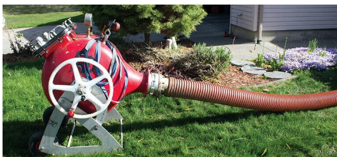
Figura 8 – Câmara de pressurização - CIPP Fonte: Vietzke Trenchless (2011)
