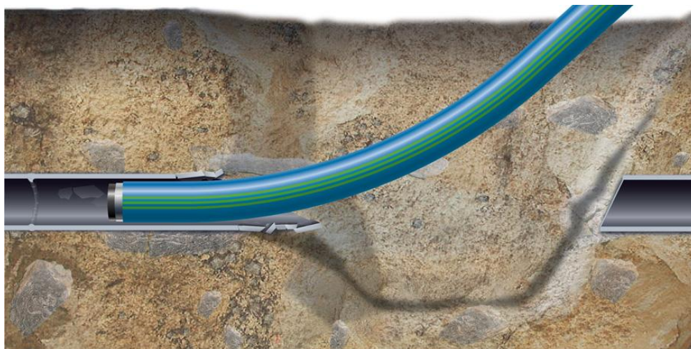
Figura 1 – Sliplining Fonte: Egeplast (2021)
