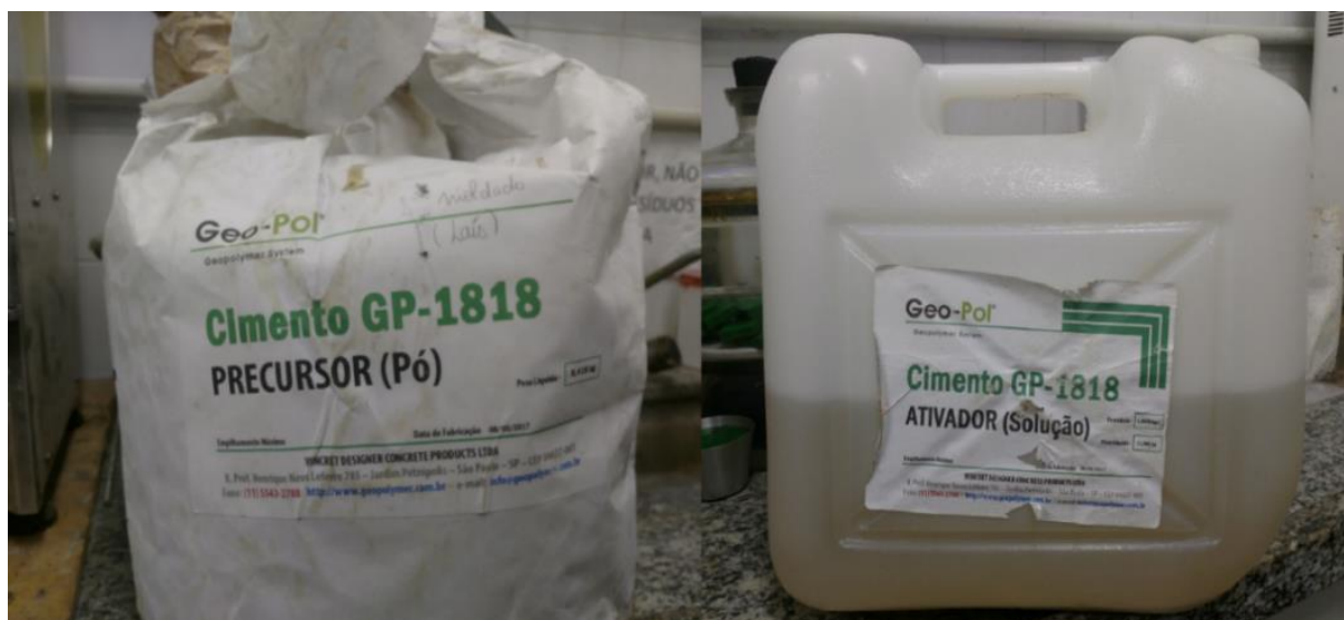
Figura 13: Componentes do Cimento GP-1818. a) Pó precursor e b) líquido ativado.
