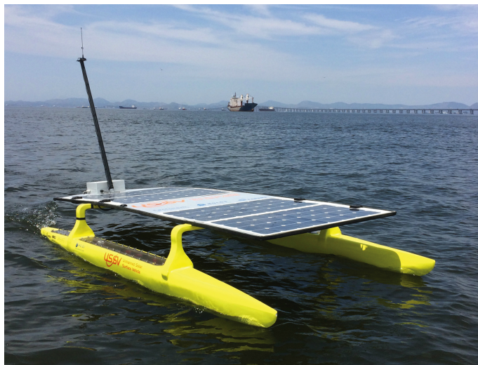
Figura 1.1: Catamarã autônomo movido por energia solar Fonte: Revista Pesquisa FAPESP [38]
