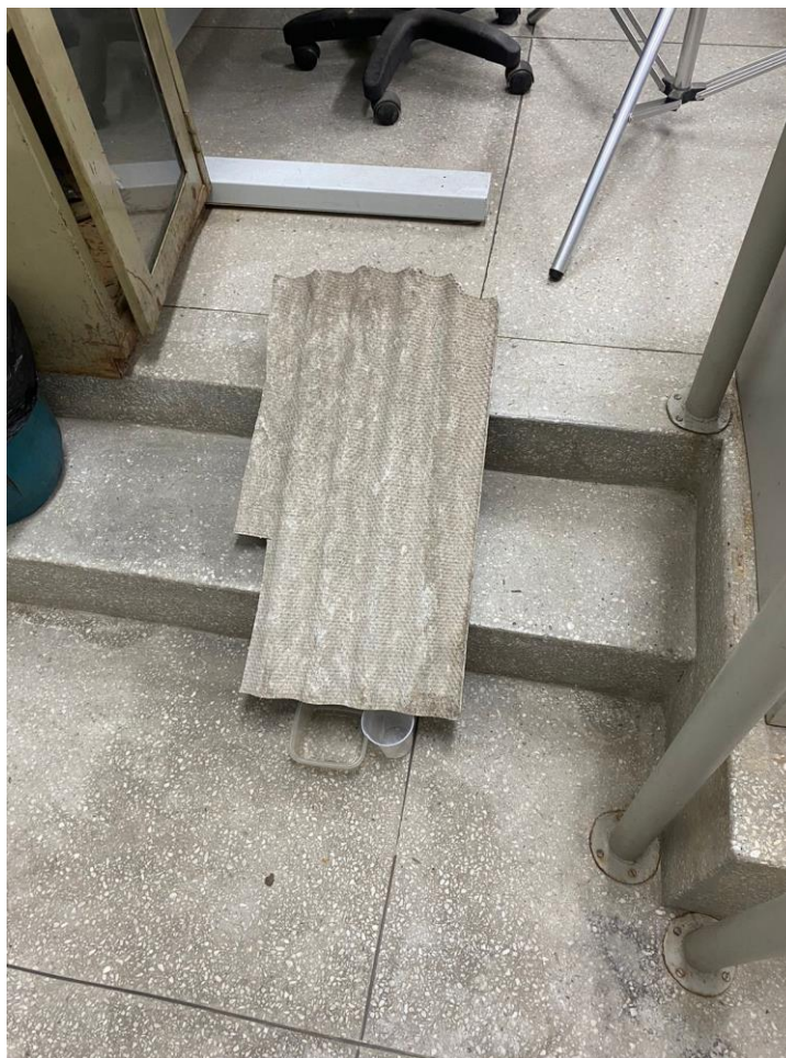
Figura 27: Telha inclinada para o teste Fonte: Os autores (2023)
