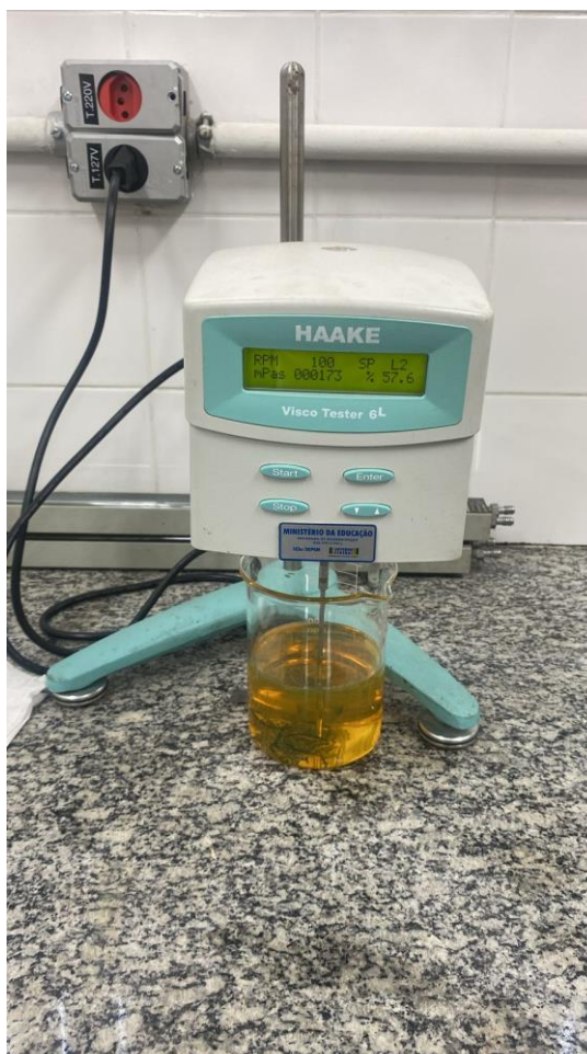
Figura 42: Resultado teste de viscosidade com 100 RPM óleo 80W contaminado Fonte: Os autores (2023)
