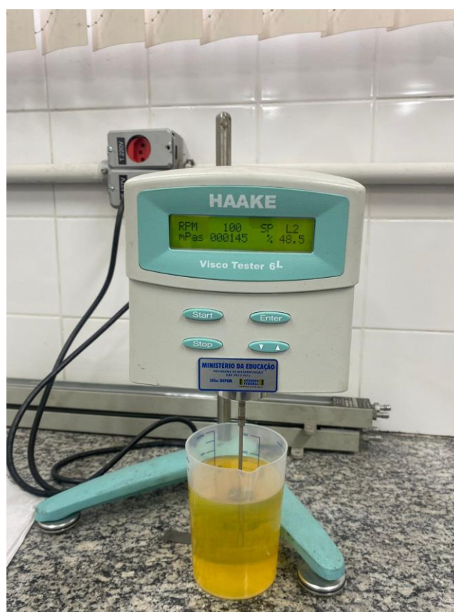
Figura 40: Resultado teste de viscosidade com 100 RPM óleo 80W limpo Fonte: Os autores (2023)
