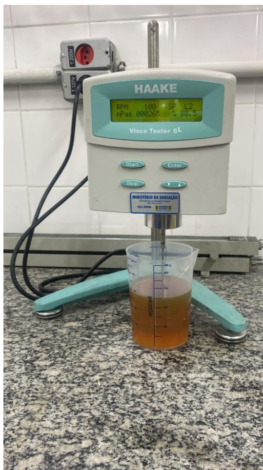
Figura 44: Resultado teste de viscosidade com 100 RPM óleo 80W90 limpo Fonte: Os autores (2023)
