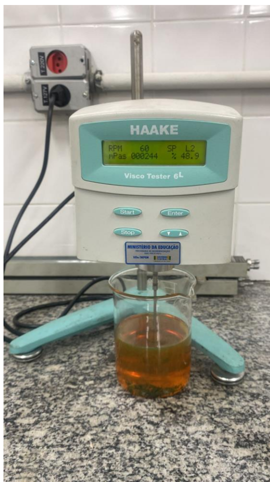
Figura 47: Resultado teste de viscosidade com 60 RPM óleo 80W90 contaminado Fonte: Os autores (2023)
