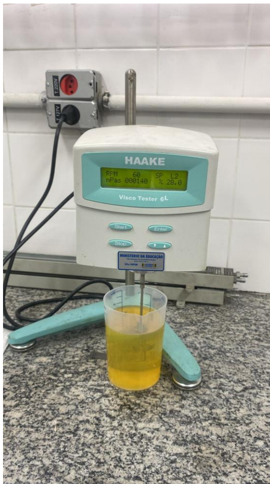
Figura 41: Resultado teste de viscosidade com 60 RPM óleo 80W limpo Fonte: Os autores (2023)
