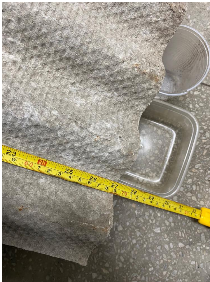
Figura 28: Comprimento da telha Fonte: Os autores (2023)
