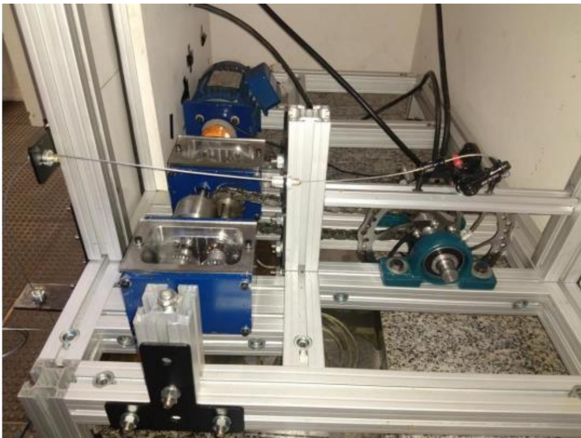
Figura 15: Tribômetro FZG Fonte: Lenine Marques (2021)
