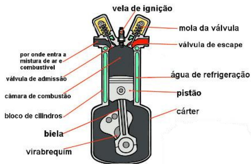
Figura 1: Componentes de motor de combustão interna. Fonte: FOGAÇA, 2021
